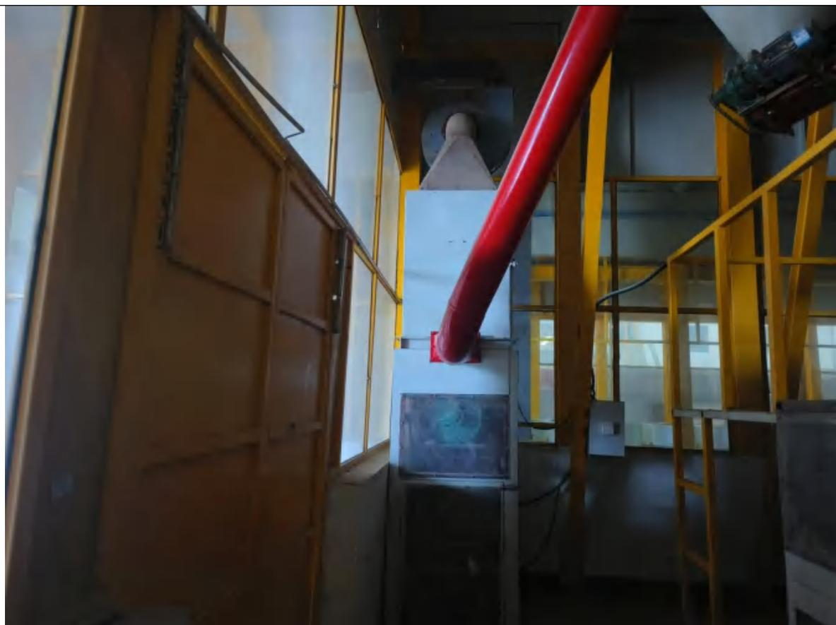
配粉工序配粉、搅拌粉尘布袋除尘器废气处理设施
