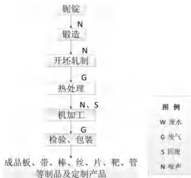
图 2-4 钽制件生产工艺流程及产污环节图
